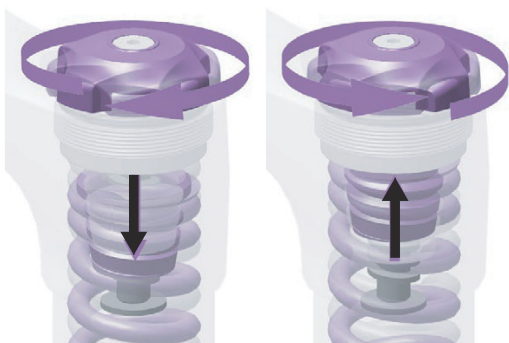
Abbildung 82: Vorspannungseinstellung herein und heraus drehen.
