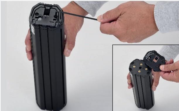
Abbildung 44: Demontage oberes Interface
