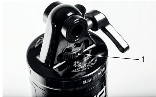
Abbildung 91: Suntour-Zugstufeneinsteller Rad (1) am Hinterbau-Dämpfer
