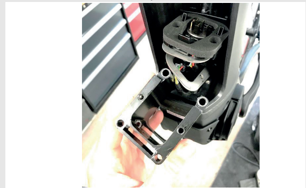
Abbildung 38: PowerTube Adapter herausziehen
