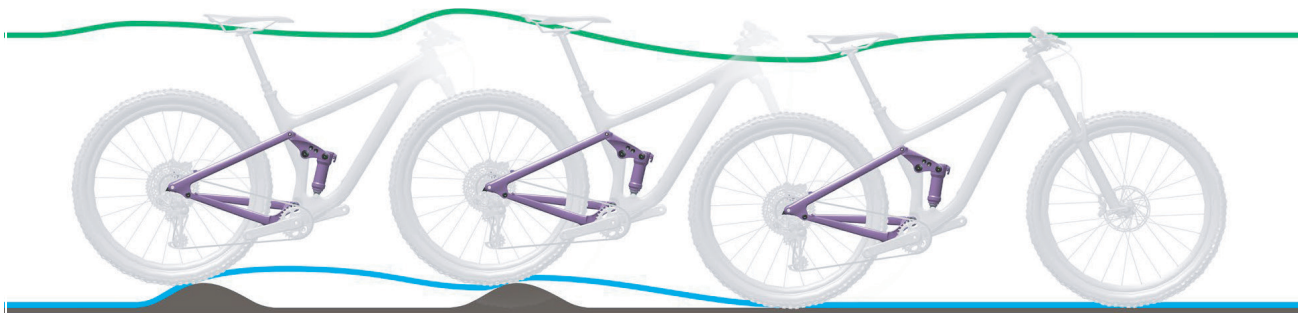
Abbildung 144: Zu langsames Ausfedern des Hinterbau-Dämpfers
