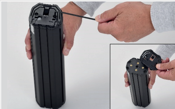
Abbildung 41: Demontage oberes Interface
