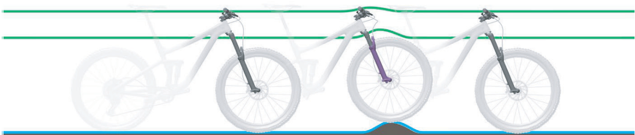
Abbildung 7: Optimales Fahrverhalten der Gabel bei Unebenheiten
